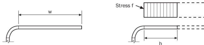
شکل ۲-۹ اجزای سخت‌نشده تحت اثر فشار یکنواخت
