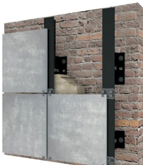
شکل ۷-۲۲- اجزای سیستم نصب نمایان
